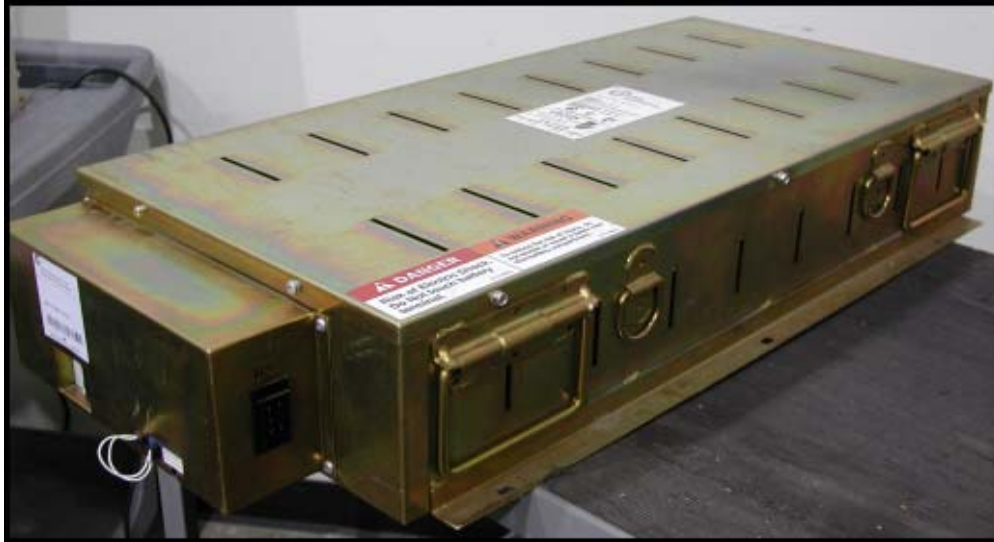
Рисунок 52 Блок аккумуляторных батарей
