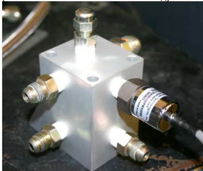
Рисунок 40 Воздухораспределитель вспомогательной воздушной системы
