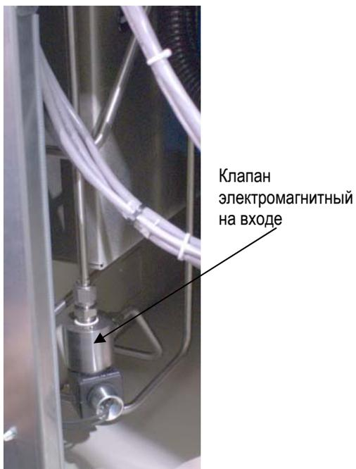
Рисунок 29 Электромагнитный клапан на входе в ГТЭА
