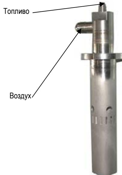
Рисунок 38 Инжектор для жидкого топлива
