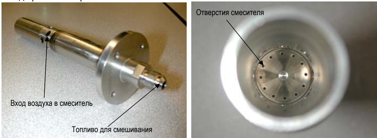
Рисунок 37 Инжектор для газового топлива
