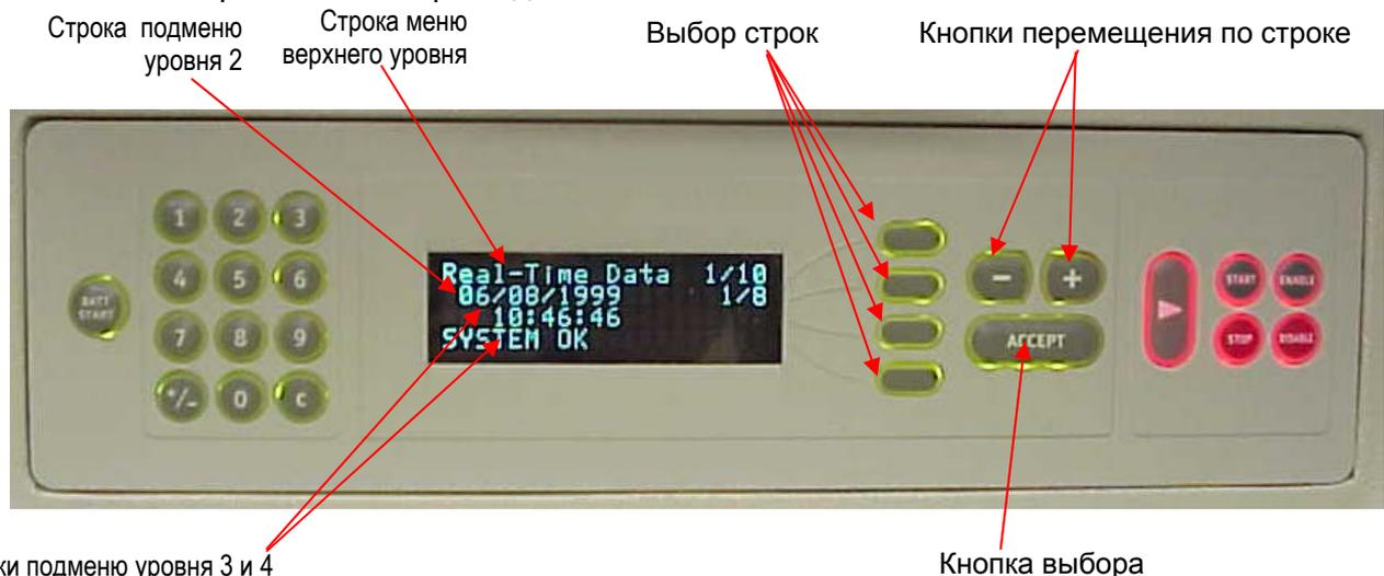
Рисунок 59 Экран и кнопки навигации
