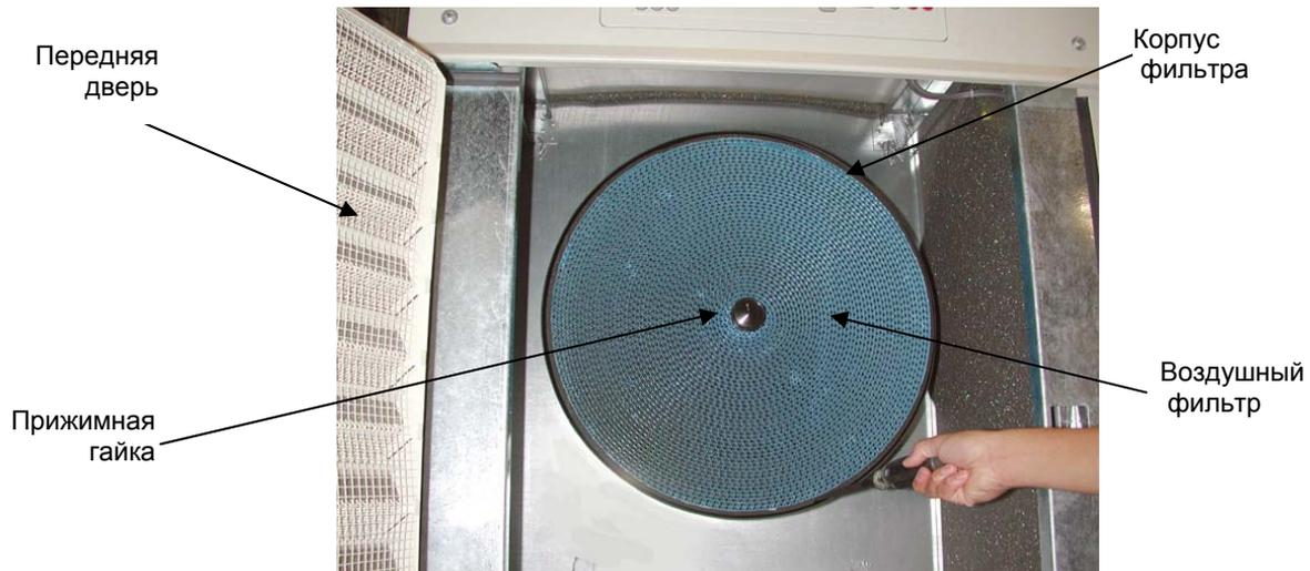
Рисунок 100 Воздушный фильтр циклового воздуха
