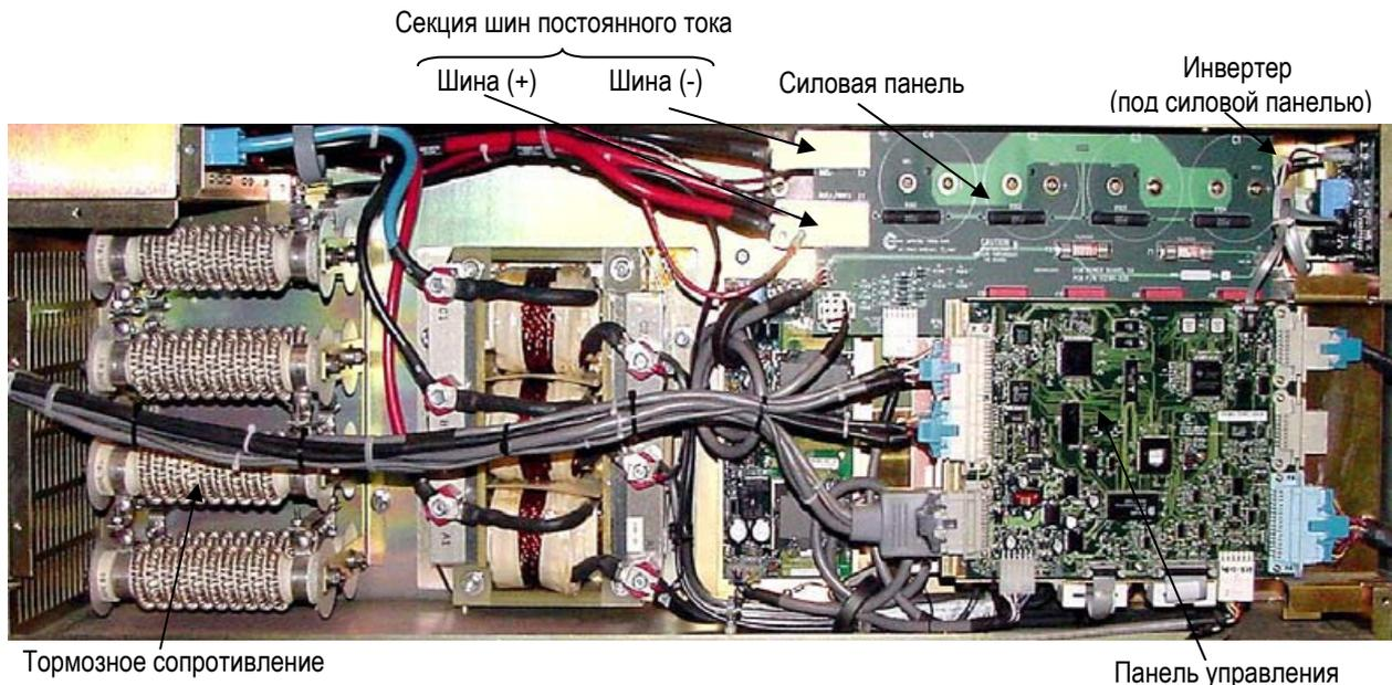
Рисунок 42 Модуль управления турбогенератором
