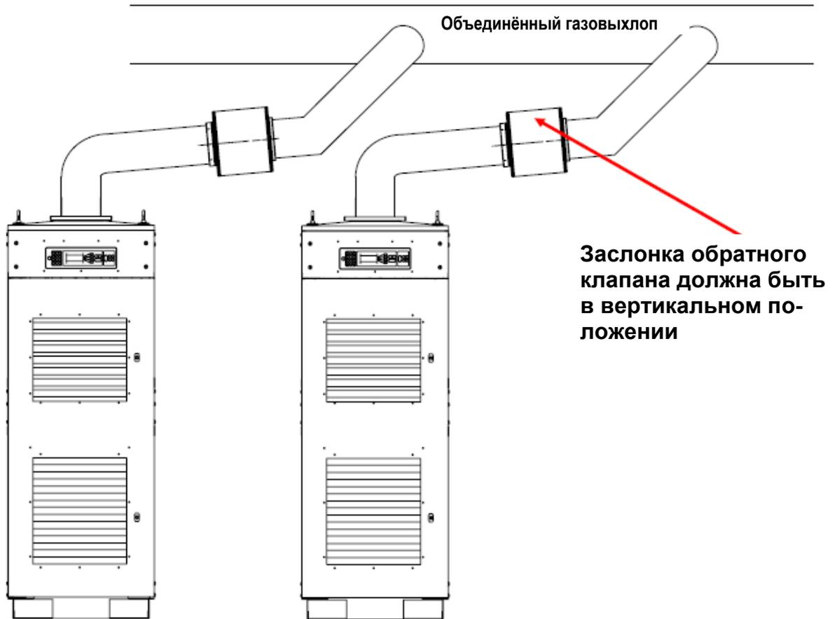
Рисунок 93 Вариант установки обратных клапанов
