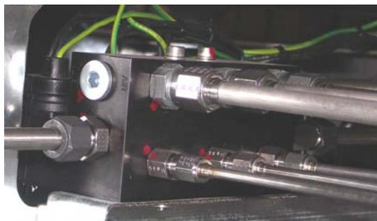
Рисунок 32 Топливораспределитель жидкотопливной системы
