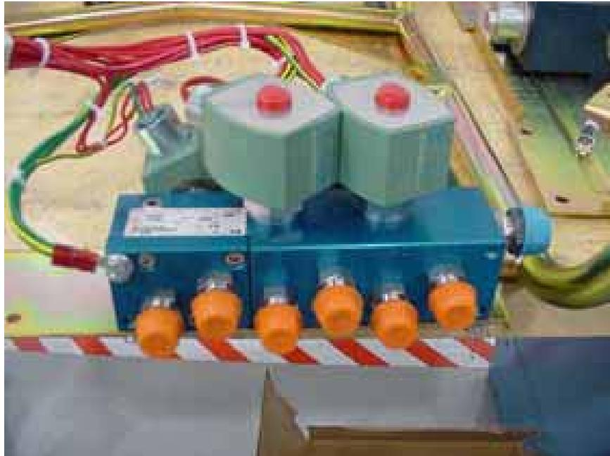
Рисунок 24 Топливораспределитель
