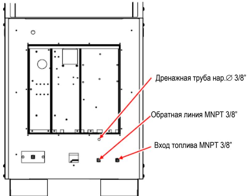
Рисунок 28 Места присоединения топливной линии
