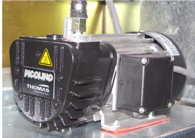
Рисунок 33 Воздушный компрессор с приводным электродвигателем
